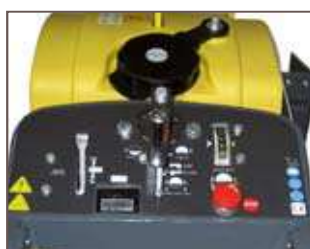
Kontrollpanel med elektronisk mätare för arbetstimmar
